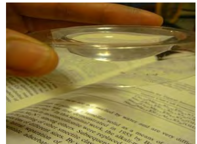
圖表 1 塑膠盒裝水做成的水透鏡
