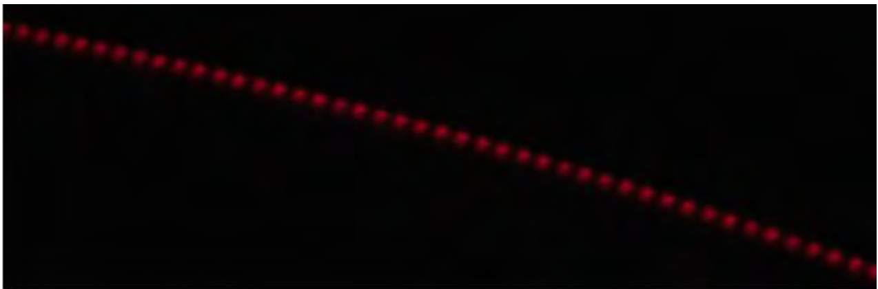
圖 2、雷射光通過傾斜光柵片時彎曲的情形
