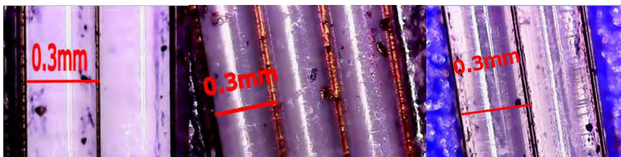
圖 19: 左、中是市售光柵片以 USB 顯微鏡測量間距；圖右是以釣魚線緊密排列的自製光柵片
