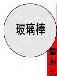
圖 35：雷射光照射玻璃棒邊緣，漏出些微的光，使得照到玻璃雷射光小於原本的寬度。
