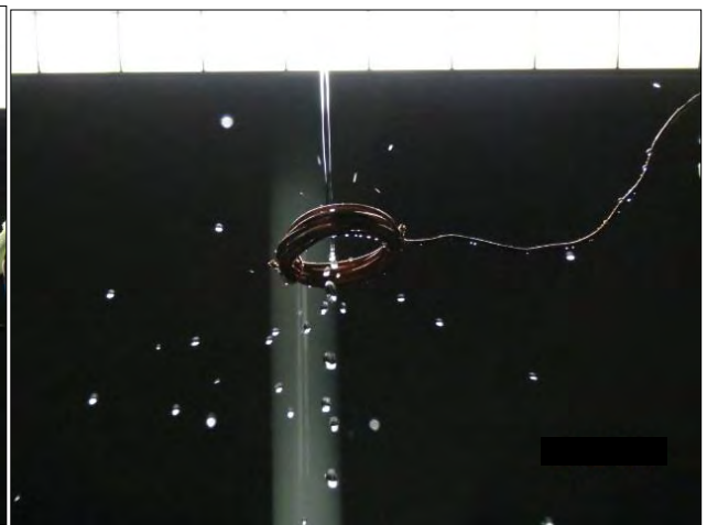
圖 9 靜電環通電，水滴裂解而散開(快門 1/1600)
