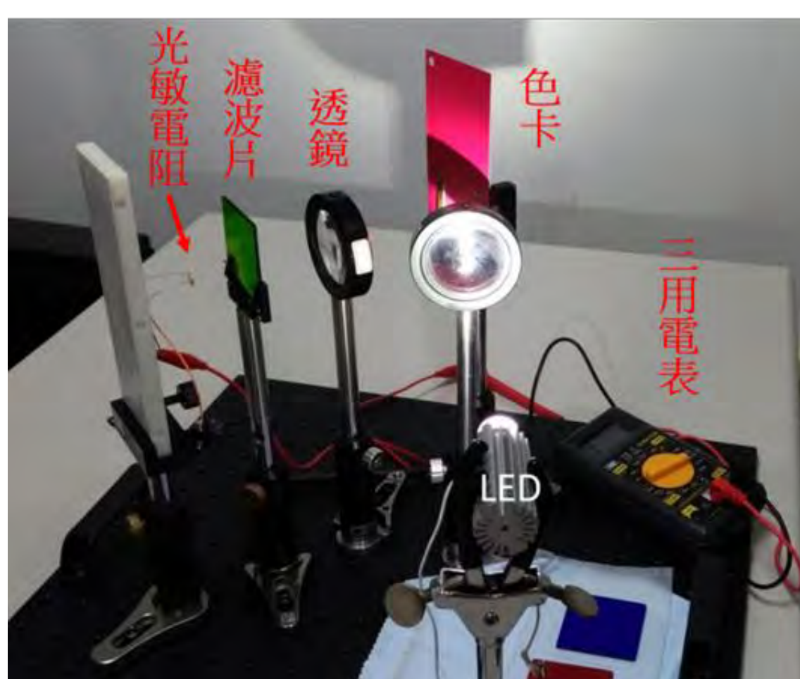
圖10 利用光敏電阻值量測的實驗架構
