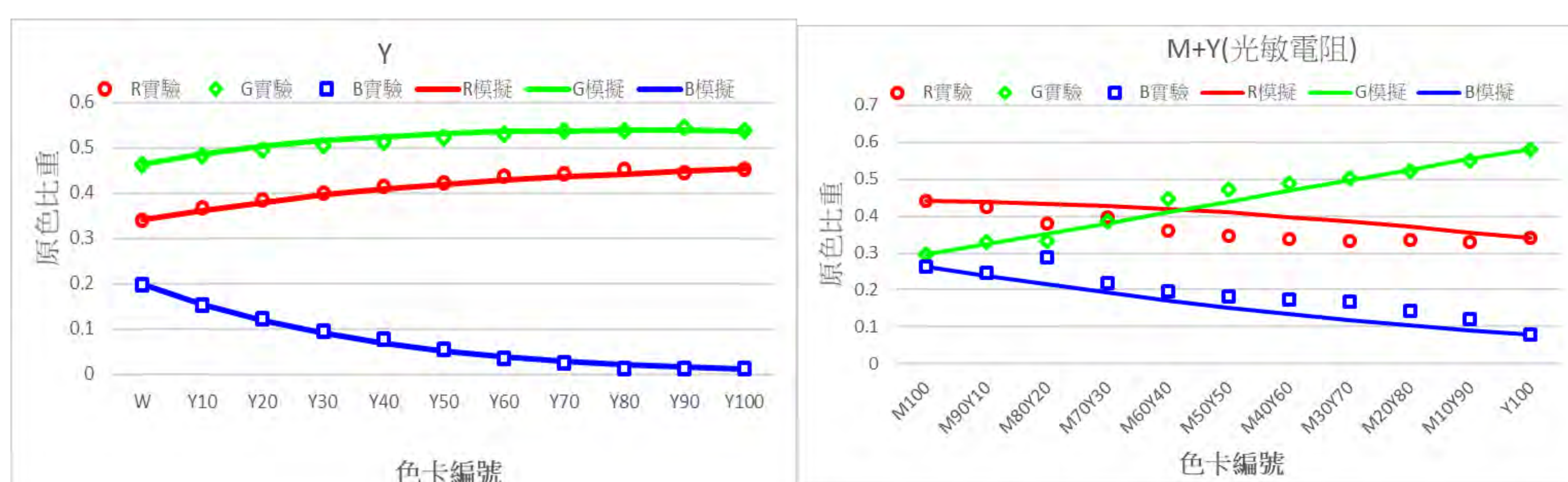
圖14 模擬與實驗比較圖 (a)功率計量測單顏色原色，黃色改變 (b) 光敏電阻量測雙色混合，洋紅色與黃色改變。
