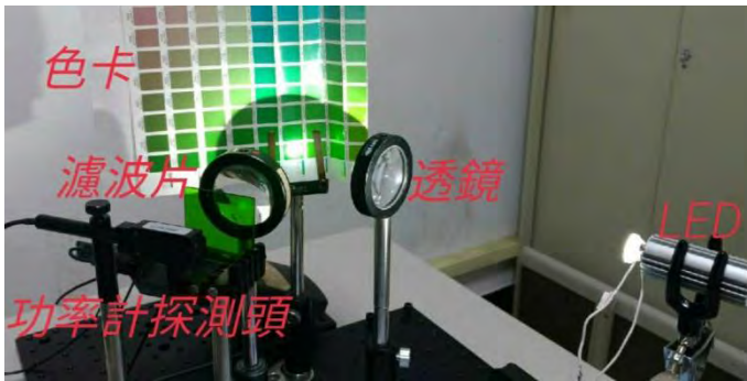
圖 4-4 利用功率計進行顏色分解的實驗架設
