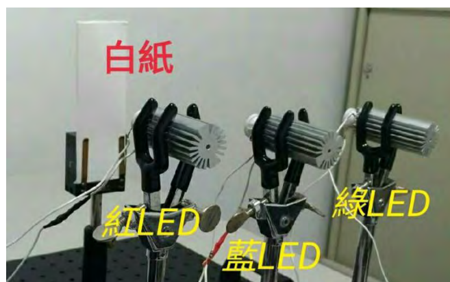
圖 4-3 原色分析的實驗架構
