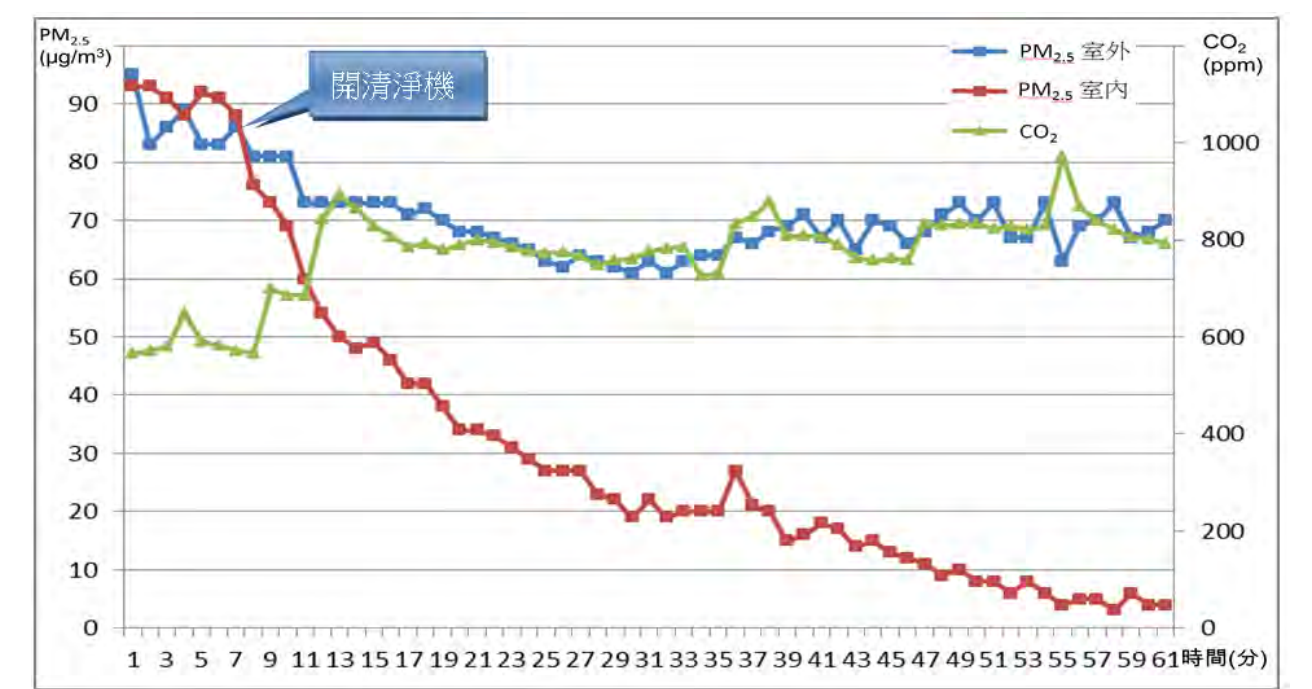
▲圖23：實驗9—使用象鼻裝置實測的PM 2.5 和CO 2 濃度變化折線圖
