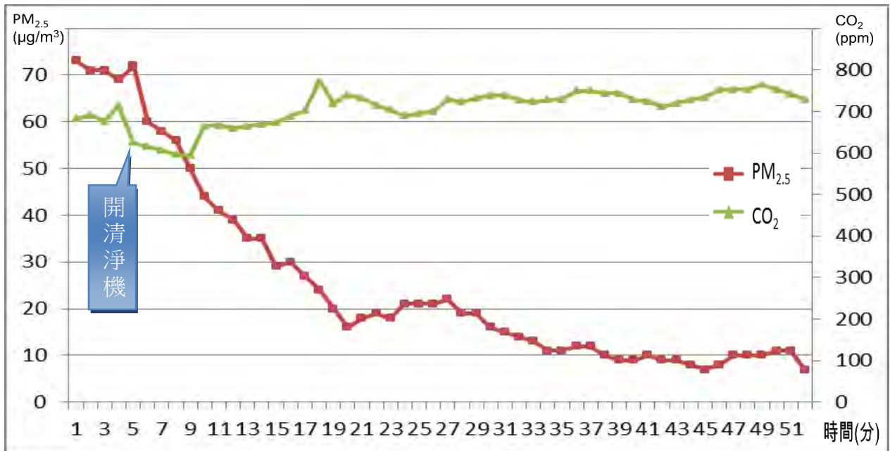
▲圖 13：實驗 7-1—清淨機置於教室窗台並關閉門窗之 PM 2.5 和 CO 2 濃度變化折線圖(第 1 次實驗)
