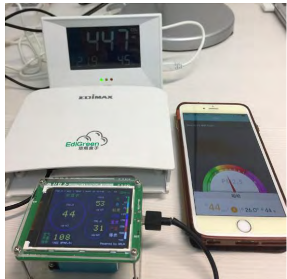
▲圖 8：實驗四—同步觀測室內之 PM 2.5 和 CO 2 (PM 2.5 檢測儀與空氣盒子同時使用，校正比對)
