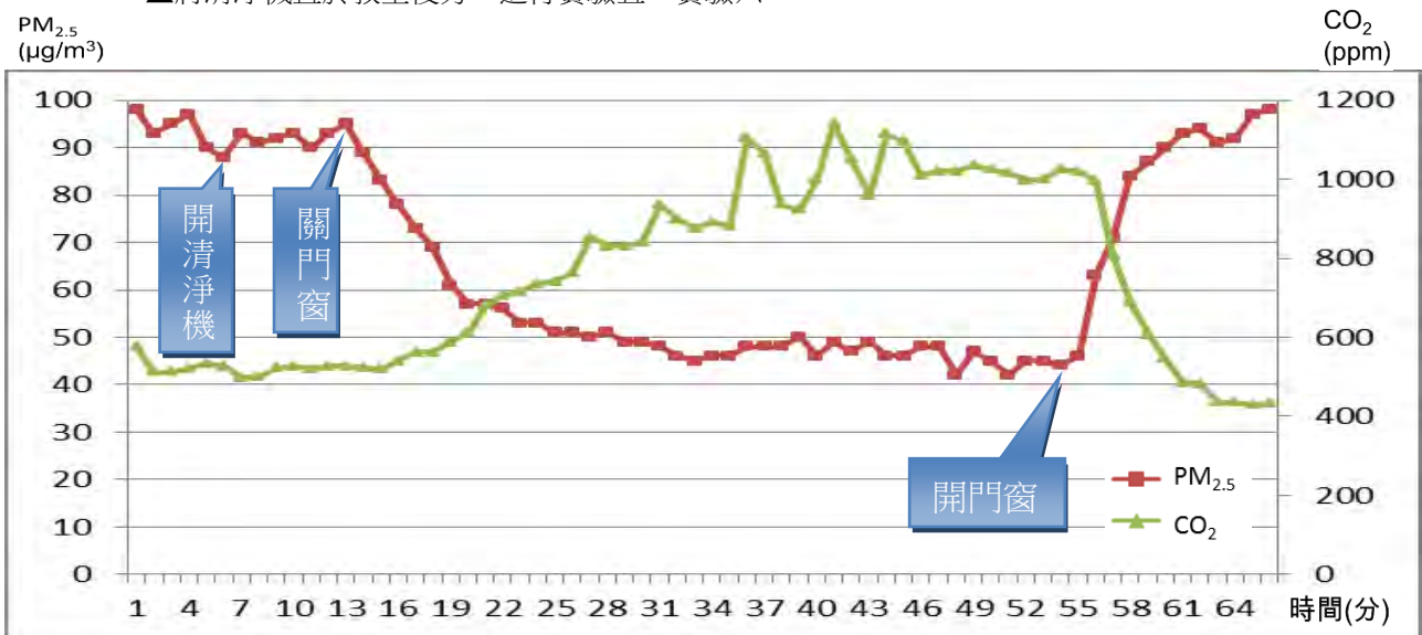
▲圖 9：實驗五(不關門窗)、實驗六(關門窗)—清淨機置於教室內之 PM 2.5 和 CO 2 濃度變化折線圖(第一次實驗)
