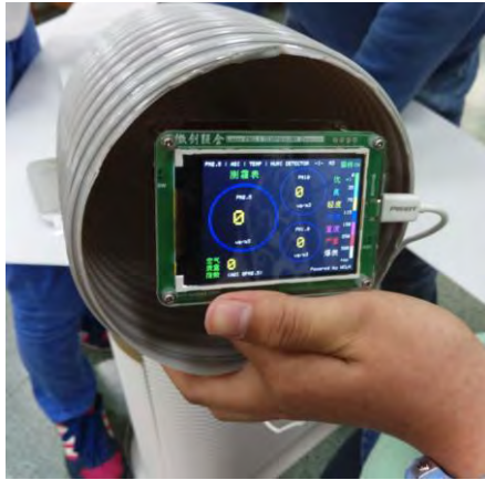
▲圖 20：實驗 9—確認出風口的 PM 2.5
