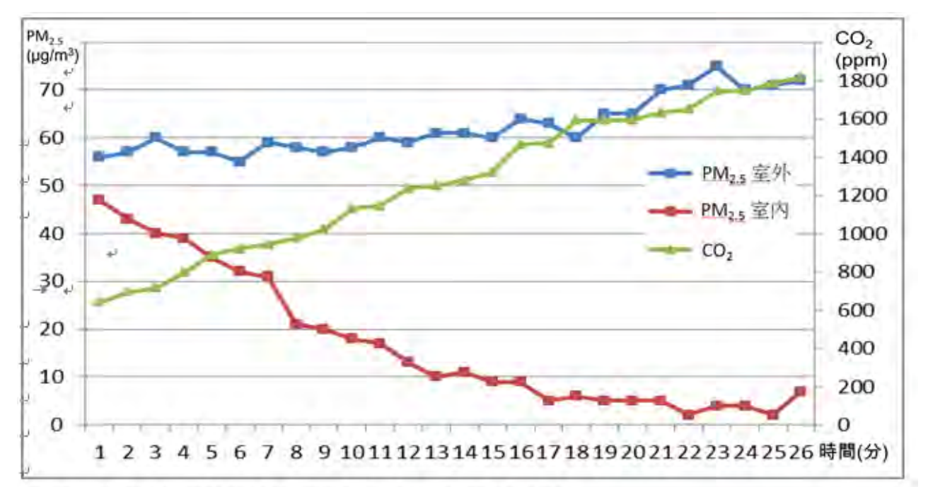
▲圖24：實驗10—清淨機放置教室後面PM 2.5 和CO 2 濃度變化折線圖
