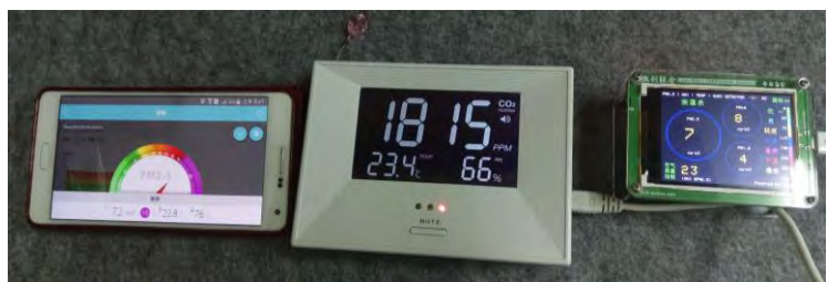
▲監測值(左：室外走廊 PM 2.5 中：室內 CO 2 濃度；右：室內 PM 2.5 )
