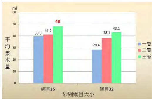
圖 33：比較不同層數(一層、兩層、三層)的淺色塑膠紗網製成的捕霧網，進行 20 分鐘捕霧效果的比較。(橫軸：網目 15(一層、兩層、三層)、網目 32(一層、兩層、三層)、縱軸：平均集水量)
