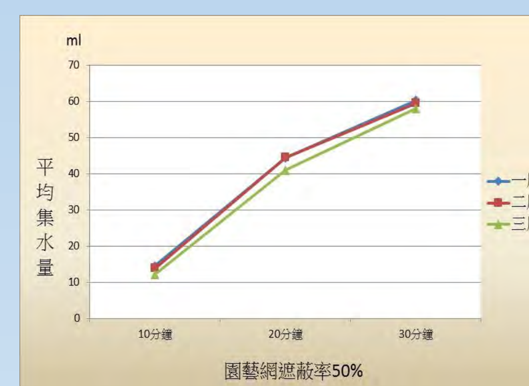
圖19：不同層數遮50% 黑網在不同捕霧時間集水量的變化
