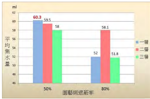
圖 31：不同層數(一層、兩層、三層)的園藝用黑色塑膠網布製成的捕霧網，進行 30 分鐘補霧效果的比較。(橫軸：遮蔽率 50%(一層、兩層、三層)、80%(一層、兩層、三層)、縱軸：平均集水量)
