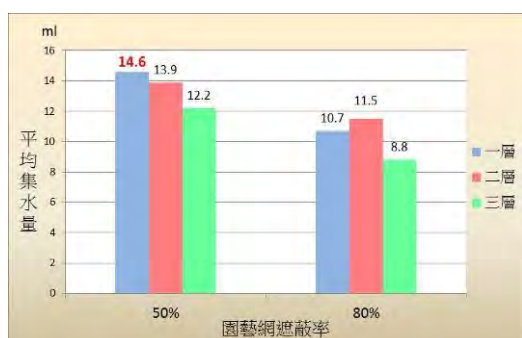
圖 29：不同層數(一層、兩層、三層)的園藝用黑色塑膠網布製成的捕霧網，進行 10 分鐘補霧效果的比較。(橫軸：遮蔽率 50%(一層、兩層、三層)、80%(一層、兩層、三層)、縱軸：平均集水量)
