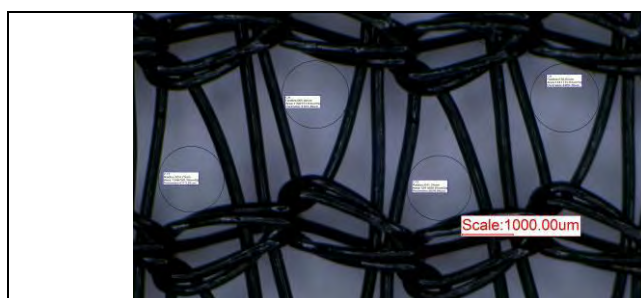
圖 19：遮蔽率 50% 黑色塑膠網的網孔大小
