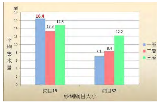
圖 32：比較不同層數(一層、兩層、三層)的淺色塑膠紗網製成的捕霧網，進行 10 分鐘捕霧效果的比較。(橫軸：網目 15(一層、兩層、三層)、網目 32(一層、兩層、三層)、縱軸：平均集水量)
