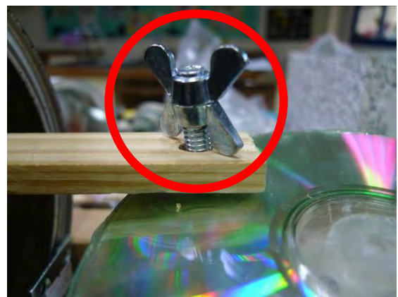
用兩個碟型螺帽鎖緊卡在上面，讓推拉棒有旋轉空間但是又不會被鎖死。 不能只用一個螺帽，因為機器的震動會讓它越鎖越緊，把推拉棒卡住！
