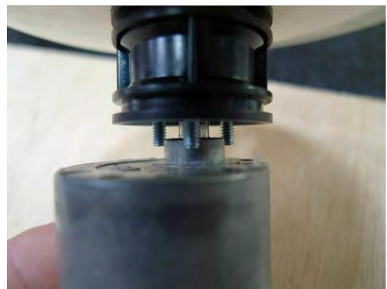
把塑膠蓋上的 3 根螺絲釘插進樂高車輪的洞裡。
