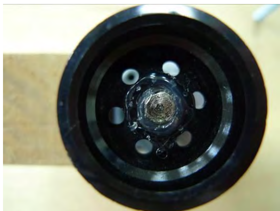
把樂高車輪用快乾強力膠黏在馬達軸心上
