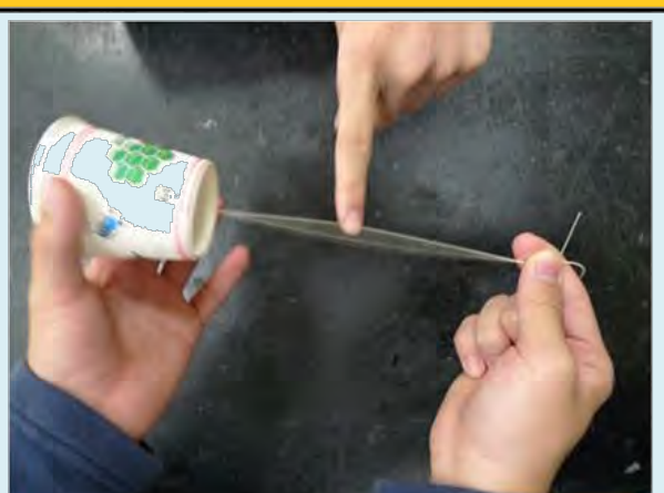
線加上紙杯(音箱)，可以讓響度加大
