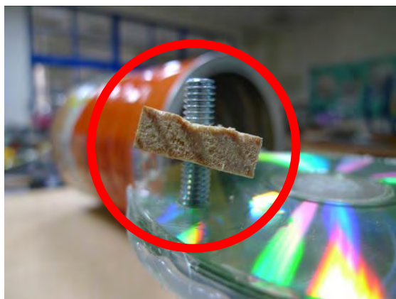
把樂高車輪用快乾強力膠黏在馬達軸心上
