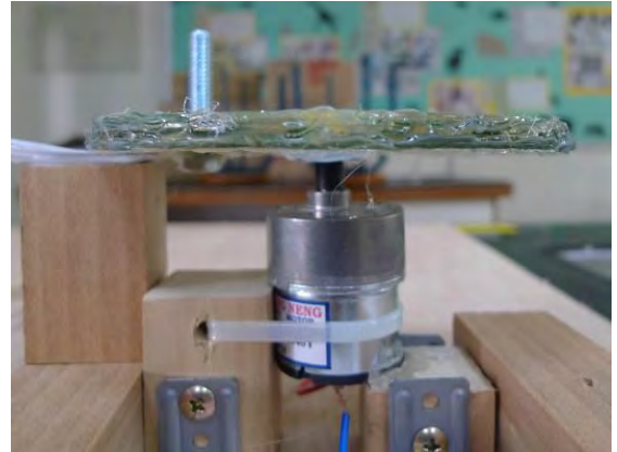
把4片光碟黏在一起，在邊緣鎖上一條螺絲，中間在用熱熔膠黏在馬達軸心上。
