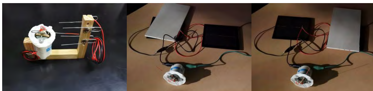
改裝指針電表為偵測器 遮左邊光電板指針偏左轉 遮右邊光電板指針偏右轉
