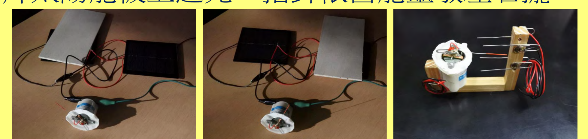
遮左邊光電板指針偏左轉，遮右邊則偏右轉 改裝電表為偵測器
