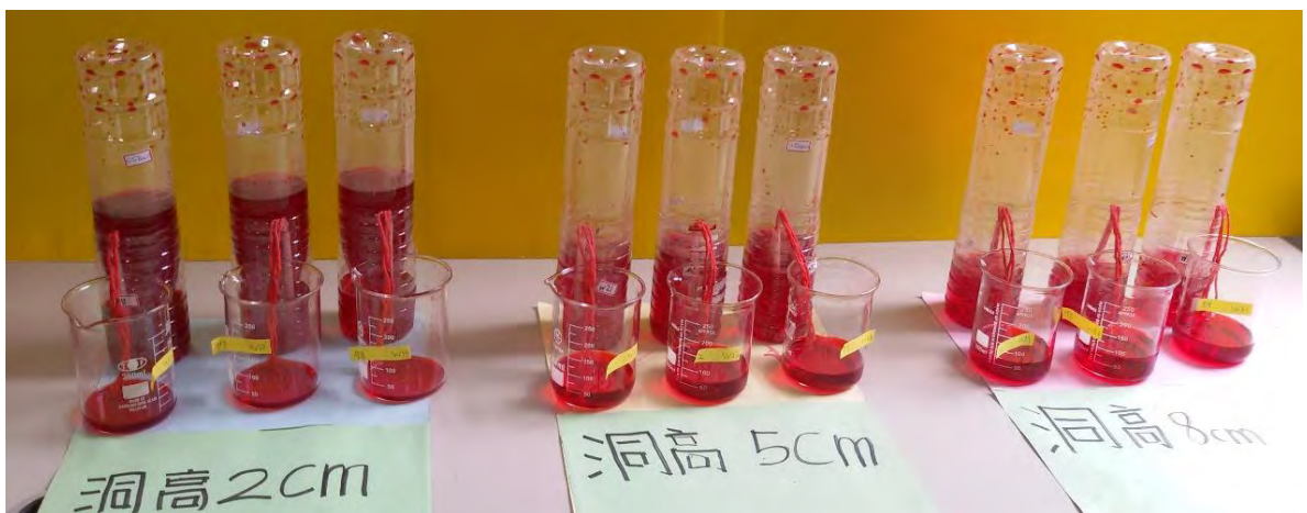
圖5. 澆水器供水瓶進氣孔的位置高低與出水量的實驗擺置
