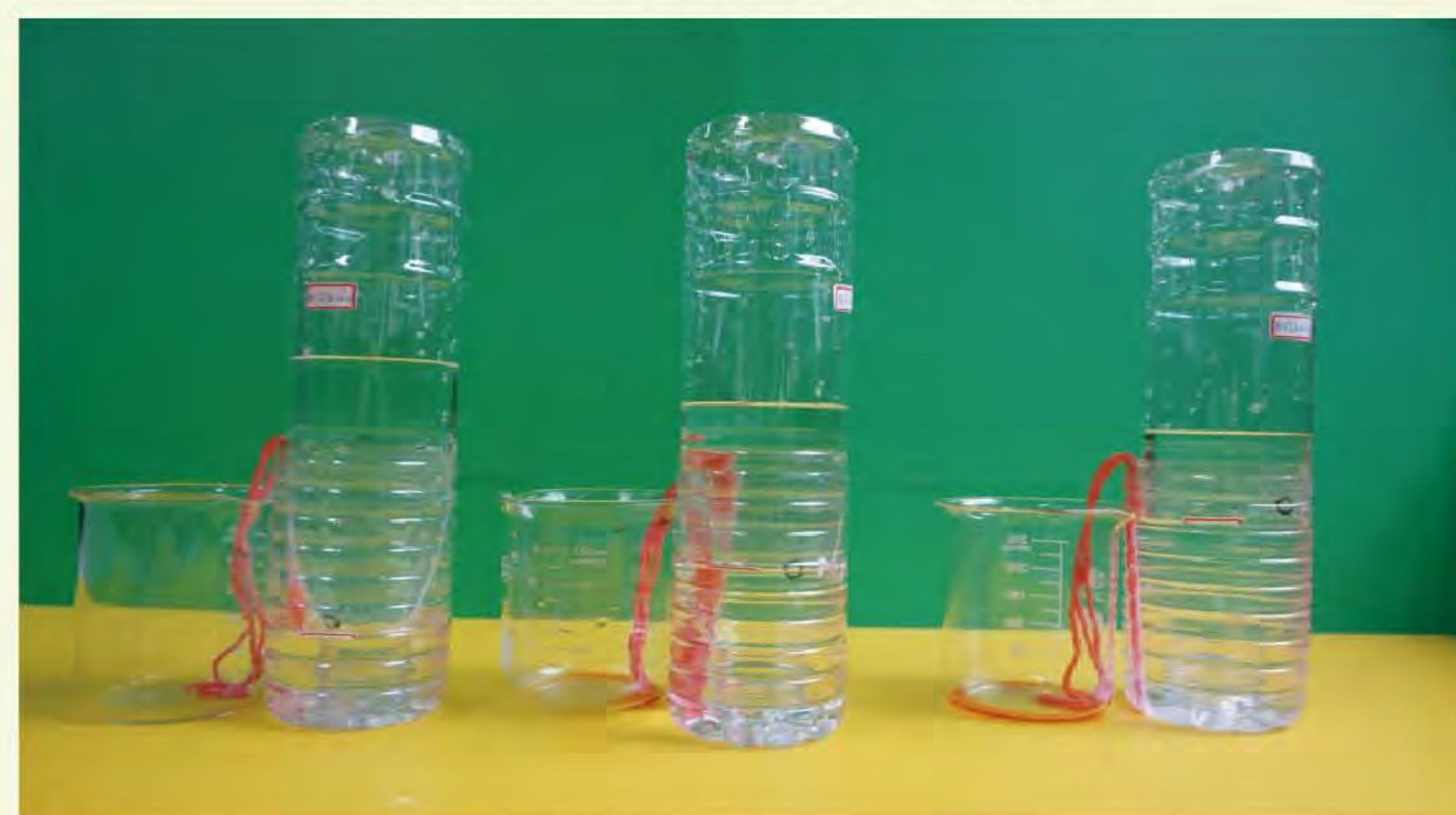
圖 3. 供水瓶的水會流到盛水容器，直到供水瓶進氣孔高度這地方。
