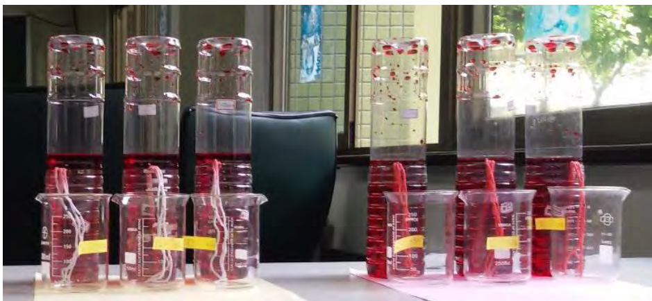
圖 4. 原本白色的棉繩因毛細作用，使供水瓶內的水附著在棉繩上，因而慢慢變紅色。
