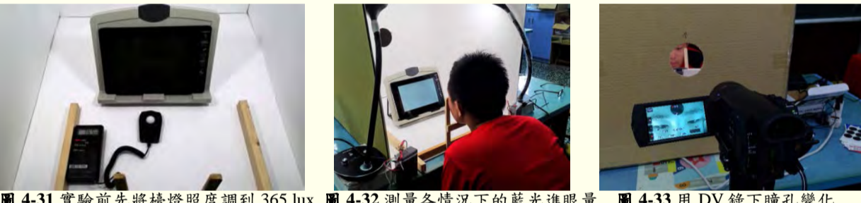
圖 4-31 實驗前將燈照度調到 365 lux
