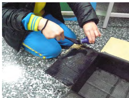
圖 3-1 製作光源測試箱支架 圖 3-2 製作彩虹黑箱-內部抹黑減少反光 圖 3-3 測試色彩恆常性的背景箱、檯燈、支架
