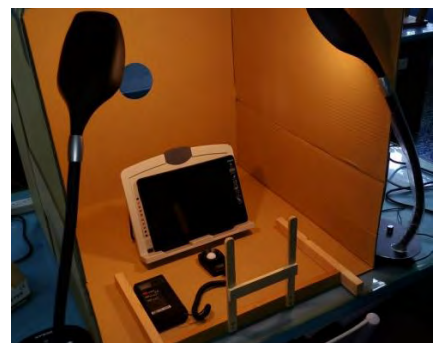
圖 3-1 製作光源測試箱支架 圖 3-2 製作彩虹黑箱-內部抹黑減少反光 圖 3-3 測試色彩恆常性的背景箱、檯燈、支架
