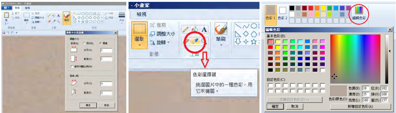
圖 4-8 將拍攝的照片縮與一個像素 圖 4-9 單色彩選擇器點選像素 圖 4-10 以編輯色彩功能記錄 RGB 值
