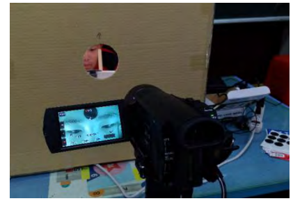
圖 4-31 實驗前先將檯燈照度調到 365 lux 圖 4-32 測量各情況下的藍光進眼量 圖 4-33 用 DV 錄下瞳孔變化
