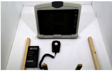
圖 4-31 實驗前先將檯燈照度調到 365 lux 圖 4-32 測量各情況下的藍光進眼量 圖 4-33 用 DV 錄下瞳孔變化
