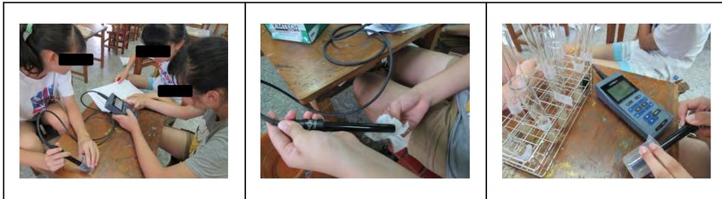
利用電導度儀分別測試混合土及校園土之導電率數據
