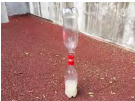
圖 5-5 第一代太陽蒸餾器面積太小
