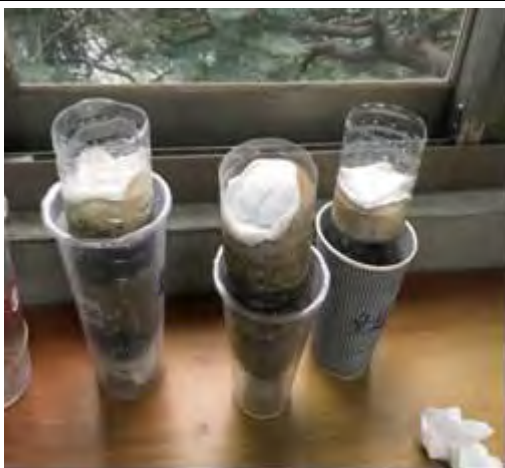
利用小的寶特瓶、二手的活性炭、過濾棉、細砂、石英砂練習過濾
