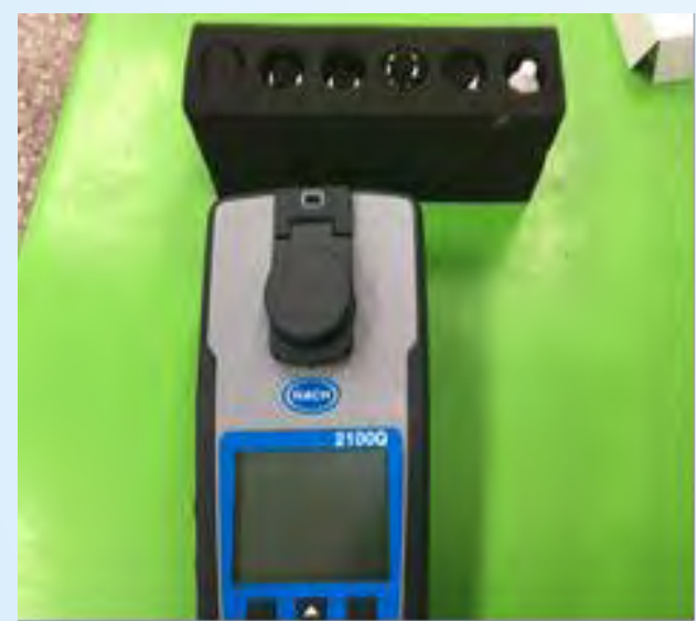
專業濁度計 專業濁度計HACH 廠牌，型號H2100Q 的濁度計作為檢驗儀器，是目前官方針對野外水質檢驗所挑選的專業攜帶型濁度計，量測範圍在0-1000NTU之間，超過範圍便無法顯示確切數據，網路價41300元。
