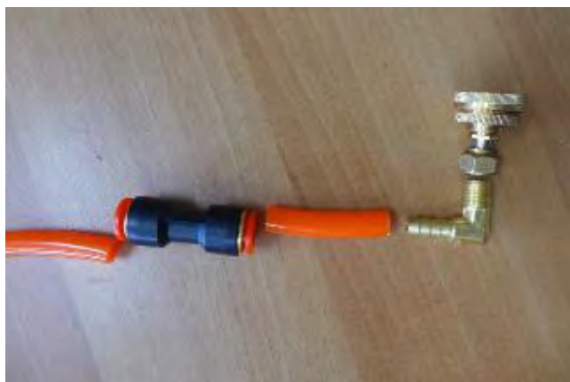
後來我們把遇到的問題詢問五金行老闆，老闆建議我們換另一種較硬的水管，並用塑膠管連接器可以連接水管並隨時抽換噴頭
