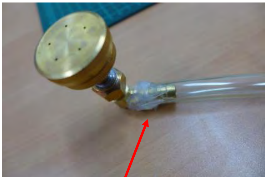
用透明水管連接噴霧頭，並用熱熔膠固定
