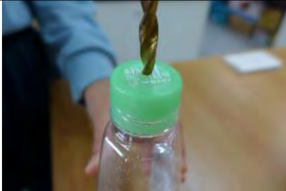
將寶特瓶瓶蓋鑽一個洞，讓發酵的氣體排出
