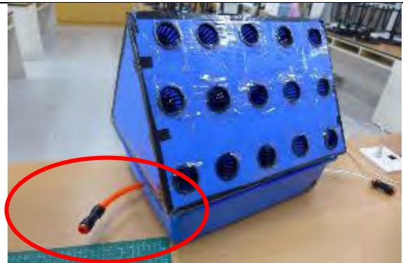
將塑膠管連接馬達。藉由馬達抽水
