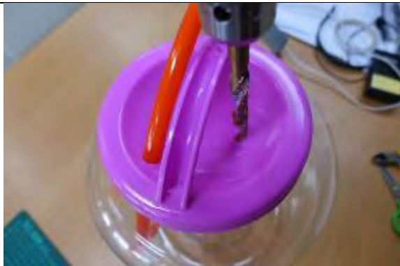
將透明水桶的蓋子上用電鑽鑽兩個洞
