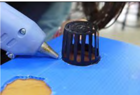
用熱熔膠將多餘的洞補滿並固定栽植盆
