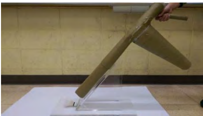
4. 將羽球收集器與待測羽球放置在固定角度的測試裝置
