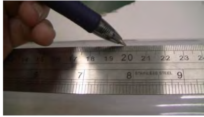
5. 距離接風口 20cm 處製作收球管開口，長度必須超過一個羽毛球長 70mm
