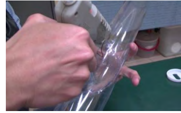
6. 捲成錐狀的塑膠板用膠帶將收集器固定，再用熱熔膠加以密合並等待冷卻
