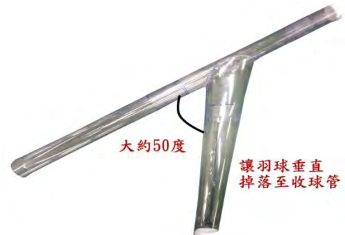
在第三代的收集器我們縮小了收球管與主體間的角度，讓收球管與主體大約呈 50 度角，讓羽球直接垂直掉落至收球管內
