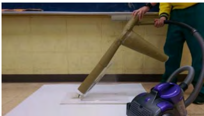
5. 接上吸塵器測試羽球收集器的吸力
