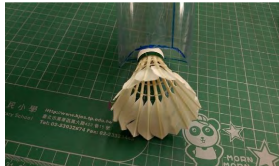
吸入端圓弧開口讓羽球球頭能先進管內(正視圖)
