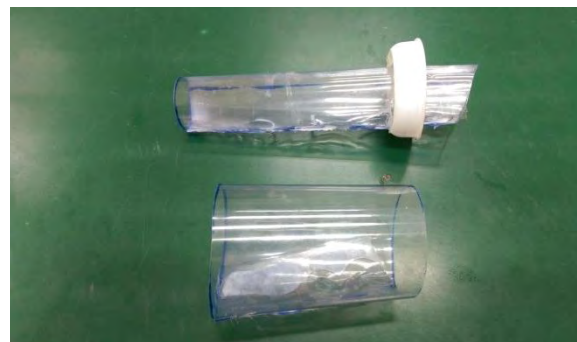
製作可伸縮延長的內外合併式接風管(分開圖)
