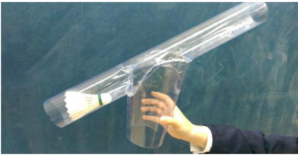
收集器主體：因使用透明的硬塑膠管，可清楚了解羽球收球過程。
