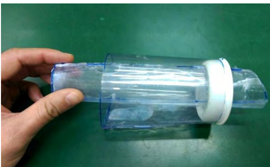
製作可伸縮延長的內外合併式接風管(組合圖)
