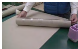
捲成 50cm 長、直徑 7.4cm 圓筒並用透明膠帶固定
