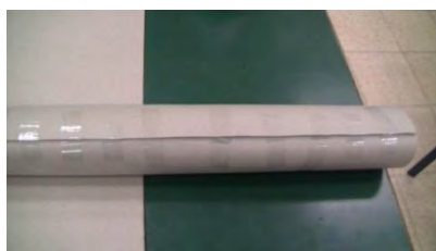
捲成 50cm 長、直徑 7cm 的圓筒，並用透明膠帶固定
