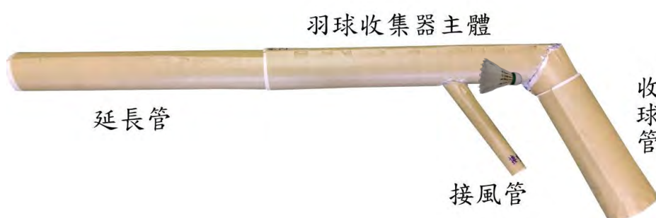
測試結果羽球卡在接風管處
