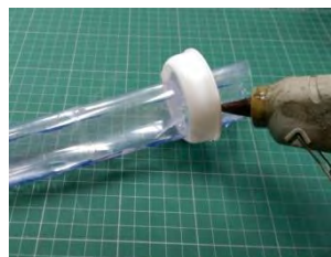
2.製作內管並用熱熔膠將接風管處接合
