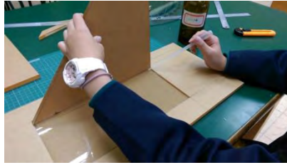
5. 用壓克力水接合固定住
