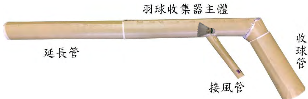
測試結果羽球卡在接風管處
