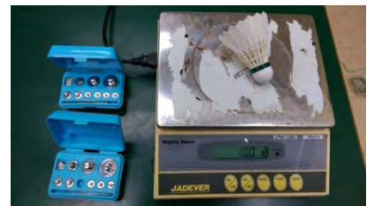
3. 將有貼砝碼的羽球放置在電子秤確認最後重量
