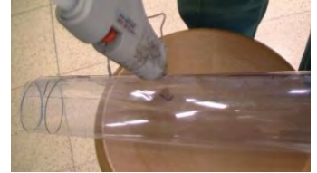
4. 使用熱熔膠讓塑膠板密合並用冷水加快冷卻
