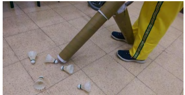
實驗發現負壓效果非常差，羽球無法吸起成串收集
