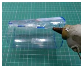
3.製作外管並用熱熔膠將接風管處接合
