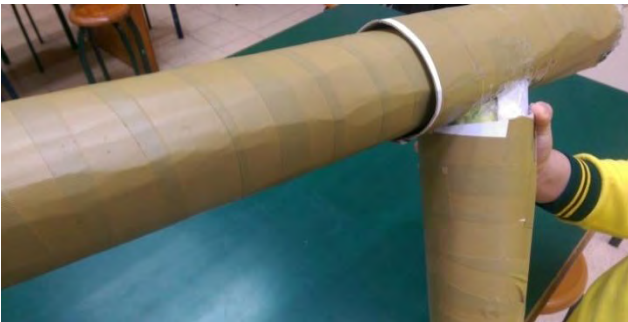
1000 磅西卡紙材質硬不易捲曲成形接合處的縫隙過大
