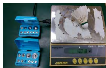
將有貼砝碼的羽球放置在電子秤量重量
