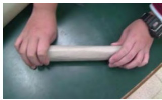
捲成 20cm 長、直徑 3cm 圓筒並用透明膠帶固定
