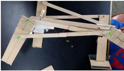
連桿未正確固定
