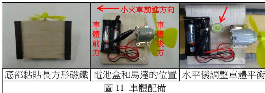
結論：車體可以用常見的樂高積木、塑膠瓦楞板、薄木板、珍珠板、壓克力板等材料製作，將馬達風扇和電池盒黏在車體上，利用水平儀調整車體平衡。
