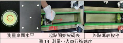
圖14 測量小火車行進速度
