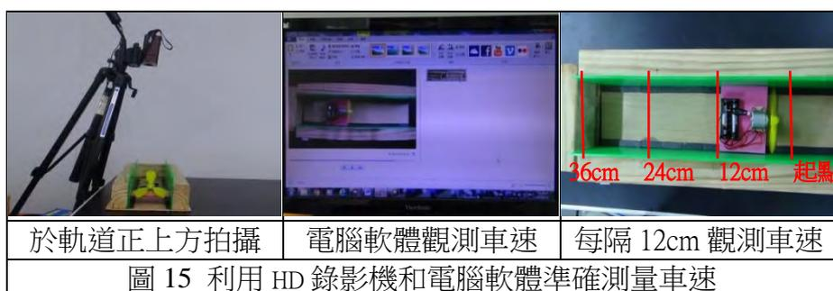
圖 15 利用 HD 錄影機和電腦軟體準確測量車速
