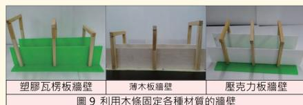
圖9 利用木條固定各種材質的牆壁
