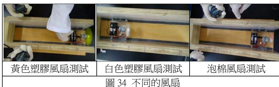
實驗四之二：控制葉片長度為 2.0cm，不同的風扇影響車速的情形，結果如表 11。
