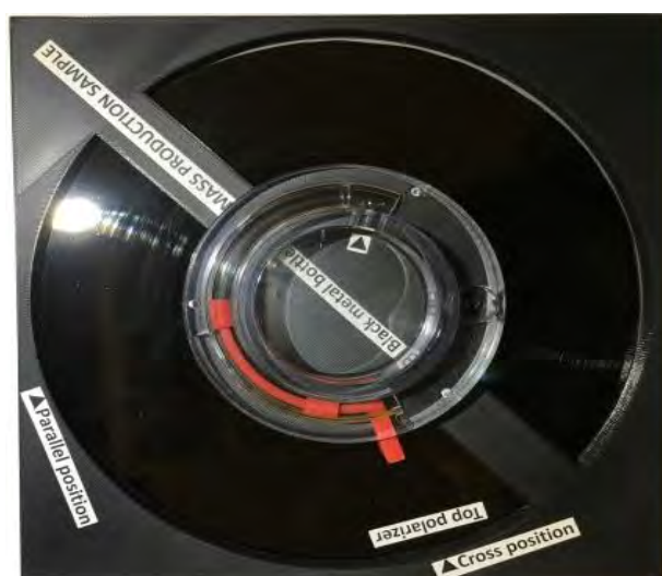
(圖 6-2-E) 偏光片夾角 90 度時
