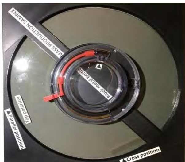
(圖 6-2-D) 偏光片夾角 0 度時
