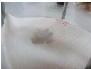
圖 5-2-2 端溪石磨製的磨液能穿透九層濾紙
