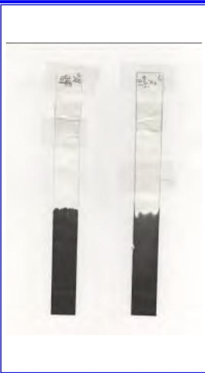
圖 5-4-3 第二次實驗--取固定距離的 5 點的高度，作平均。
