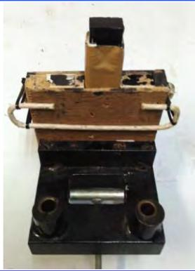
圖 4-4-2 使用自製研磨機固定磨墨條件。
