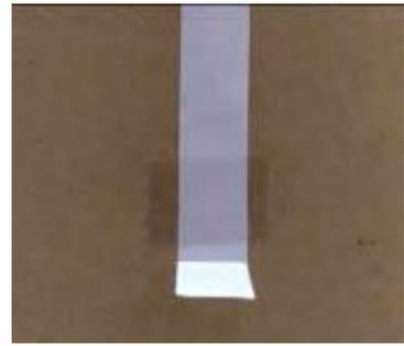
圖 4-4-3 將宣紙剪成長 20cm，寬 2cm 的長條狀，固定宣紙在培養皿中吸附墨液的面積。
