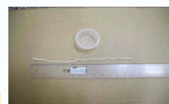
4 並將固定長度約35公分20根細棉線分別浸置於裝有醋、肥皂水、香水、廢油容器中
