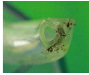
先製作一端的入水孔
