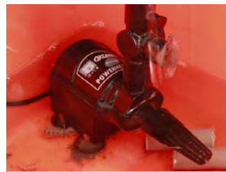
以馬達抽海水，並設分水裝置，調整水流大小
