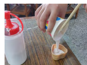
圖 91：將矽橡膠與硬化劑倒入心型模子中。
