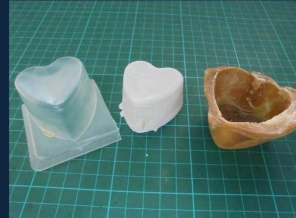
圖19：以心型模子進行鼻涕蟲製模和矽橡膠翻模。
