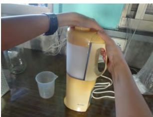
圖 6：以果汁機將粉末打成飽和溶液。
