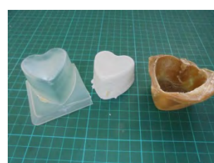
圖 93：取出的心型矽橡膠複製品與製模物比較。
