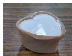
圖 92：等待矽橡膠硬化的心型鼻涕蟲模子。
