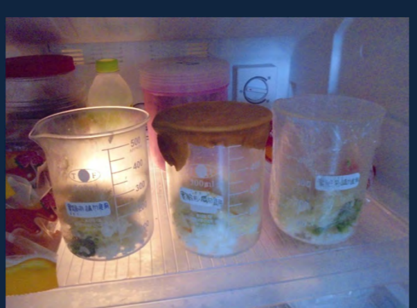
圖18：以營養午餐封上鼻涕蟲保鮮膜進行冷藏測試。
