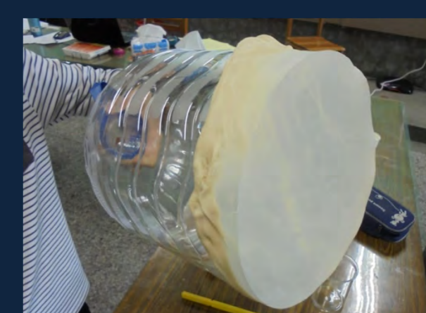
圖16：以6000ml礦泉水瓶製作的大型聲砲。
