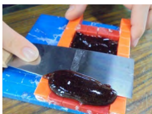
圖 22：進行檢測時要固定相同體積形狀。
