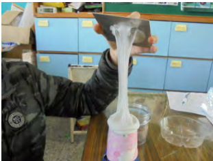
圖 32：牙膏太軟，測黏性加重物後，直接下垂
