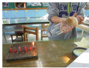
圖 71：拍打鼻涕蟲聲砲，可將燭火打熄。
