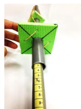
圖 4-8、發射距離測量尺
