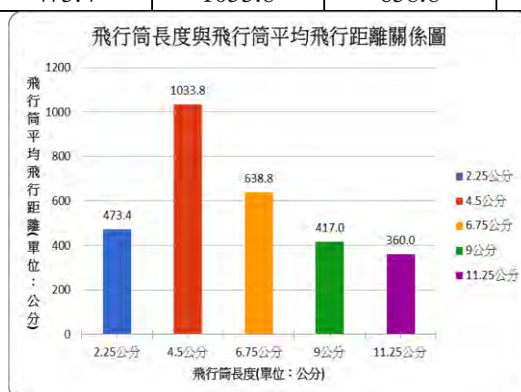
圖 6-3、飛行筒長度與飛行筒平均飛行距離關係圖
