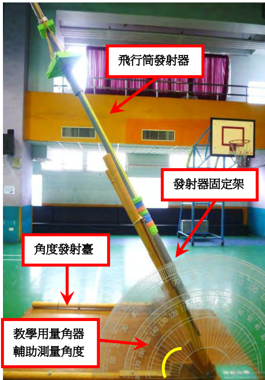
圖 4-12、飛行筒角度發射臺裝置圖
