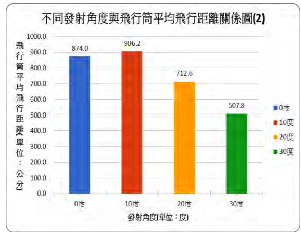
圖 6-7、不同發射角度與飛行筒平均飛行距離關係圖 (2)
