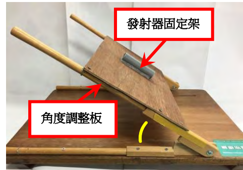
圖 4-13、飛行筒角度發射臺(側面)
