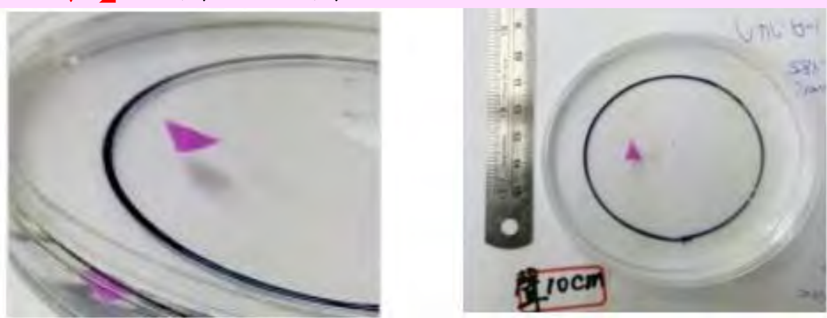
圖5-1：蠟滴滴落在固定頻率水面的凝固情形
