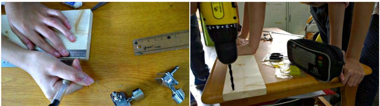
**實驗模型製作：**在 80cm 長的木板一端固定三個吉他用的旋鈕，兩個弦枕的距離 64.5cm，木板的另一端鑽三個小洞，讓三條弦穿過去剛好可以卡住，將弦另一端纏繞在旋鈕，然後轉動旋鈕直到弦被拉緊。
