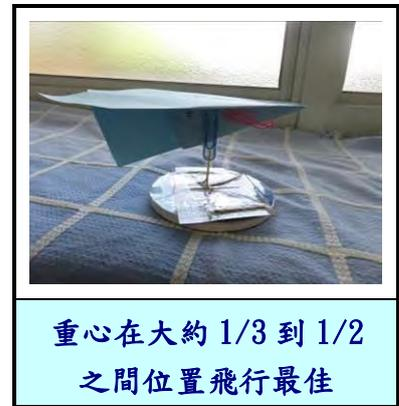
因此，重心位置也是影響紙飛機飛行的原因，如果要紙飛機飛得較遠，重心位置要落在紙飛機「機身長度 1/3 和 1/2 之間」。我們研究中的三種紙飛機的重心位置正好符合可以飛得較遠的機型之重心要求。
