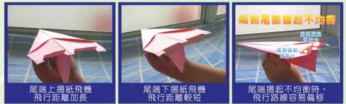
我們也想到如果尾端上摺更多，對於紙飛機的飛行又會有何影響？因此，我們進一步將摺起寬度依然固定為3cm，摺角固定為45度，但試著改變上摺的寬度再加以試驗。
