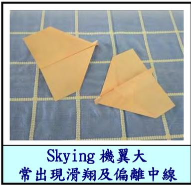
考慮紙飛機整體飛行的穩定度及橡皮筋彈性範圍，因此我們決定以拉力 25 公分，發射角度 45 度方式發射紙飛機，進行後續研究。接著我們將探討：如果機翼夾角並非水平，而是兩側機翼均揚起一點角度的話，機翼夾角對於紙飛機的飛行會有怎樣的影響呢？
