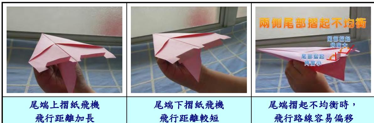
我們也想到如果尾端上摺更多，對於紙飛機的飛行又會有何影響？因此，我們進一步將摺起寬度依然固定為 3cm，摺角固定為 45 度，但試著改變上摺的寬度再加以試驗。
