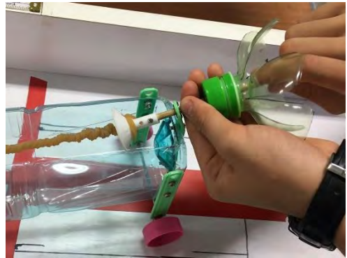
步驟 8：旋轉後方風扇軸心，放手後即可使動力車前進。
