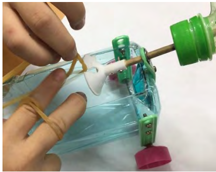
步驟 7：於氣球固定座綁上 4 條粗橡皮筋。
