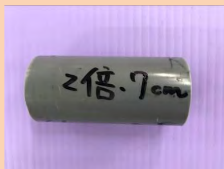
2 倍管徑的 PVC 圓管(管徑：3.5 公分)
