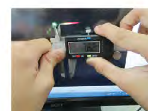
量測螢光最末端與螢光光源的距離(即圖5中的D值)
