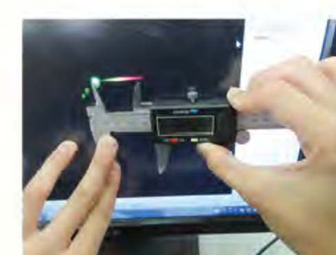
量測螢光最前端與螢光光源的距離(即圖5中的E值)
