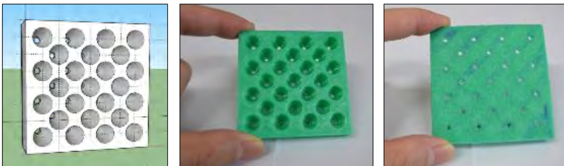
圖 7-8 以 3D 列印機製作特製導流平面模型
