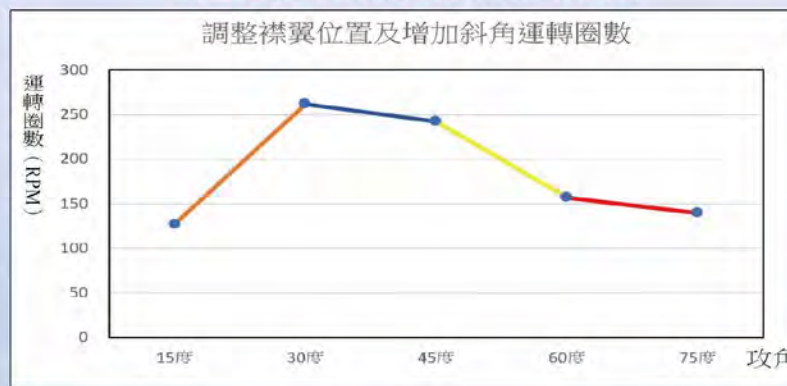
圖二-2調整襟翼位置及斜角運轉圈數圖
