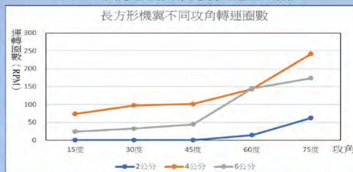
圖一-4長方形機翼不同攻角運轉圈數圖
