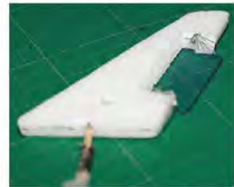
以機翼上緣為基準模擬下降襟翼30度
