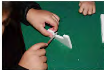
對機翼切出缺口後用挫刀磨平
