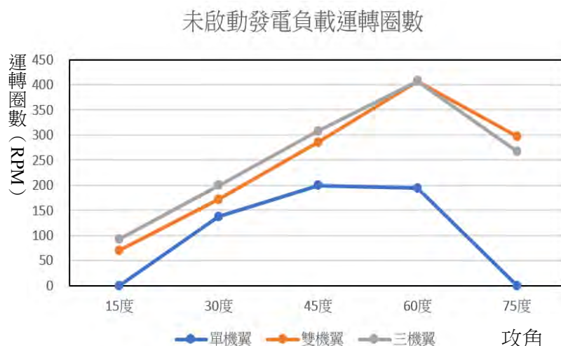
圖三-1 未啟動發電負載運轉圈數圖
