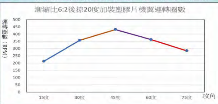
圖二-4 漸縮比6:2後掠20度加裝塑膠片機翼運轉圈數
