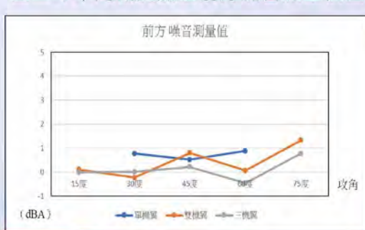
圖三-7 不同機翼數量前方噪音測量值圖
