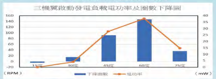
圖三-5 雙機翼下降圈數及電功率
