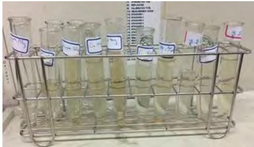
圖 5、試管離心後，取出的上層液
