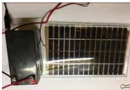
圖 36 蓄電設備-我們使用 12V 之太陽能板，在接上鉛蓄電池使其供電穩定
