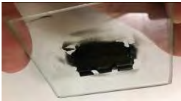
圖 39 裝置內部玻璃槽蓋，上方黑夾可夾住鈦片，使其兩面皆可照光反應
