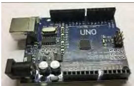
圖 43 Arduino，控制光感應器，可接上電腦分析數據或是右圖之顯示面板進行記錄
