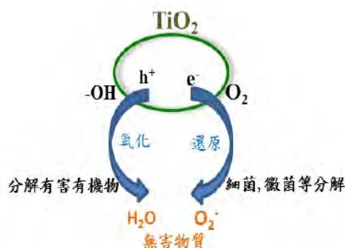
圖 1-2 二氧化鈦奈米管形成 \cdot\text{OH}^- 與 \cdot\text{O}_2^- 的機制
