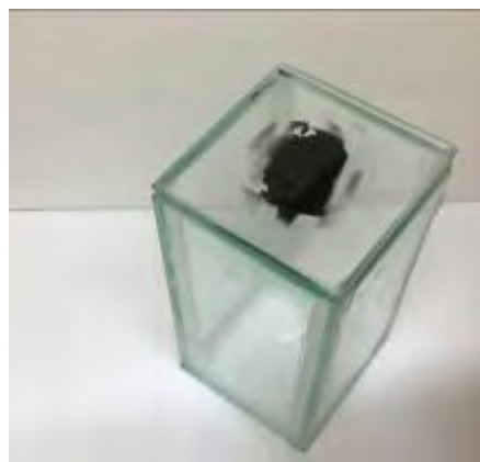
圖 40 裝置內部玻璃槽，可注入汙染物並照射紫外光進行降解
