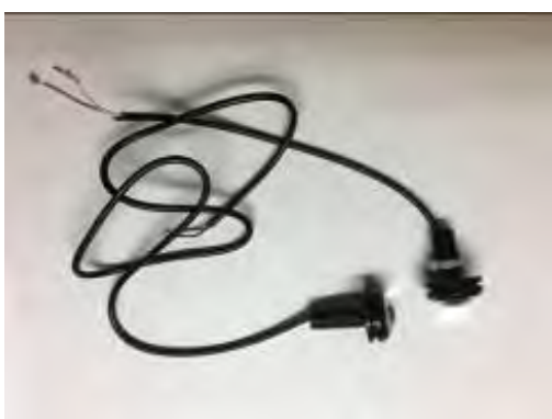
圖 41 裝置內下側之 LED 燈，照射後可經由光穿透度換算為玻璃槽內的溶液濃度，了解降解結果
