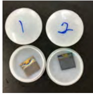
圖15、經研究後製成之鈦片 1. 0.6wt%/2mL H 2 O 2. 0.6wt%/4mL H 2 O
