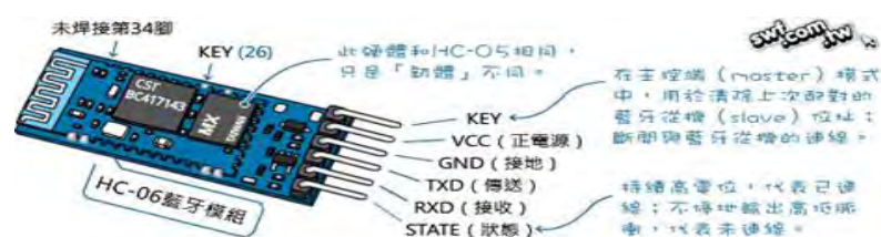
圖(十一)藍芽控制原理
