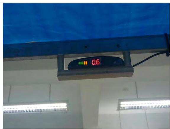
圖(十八)雷達距離顯示器(正面)
