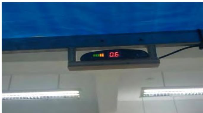
圖(八)雷達距離顯示器(正面)
