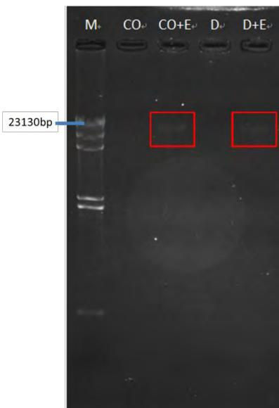
圖十四、原油和散油劑中微生物測試。M 為 Marker、CO 為原油、D 為散油劑、E 為 *E. coli* DNA。圖中可發現加入 *E. coli* DNA 的原油或散油劑皆有 DNA 表現出(紅色方框中)，原油或散油劑單獨存在時則無，故推測原油與散油劑內皆無微生物存在。
