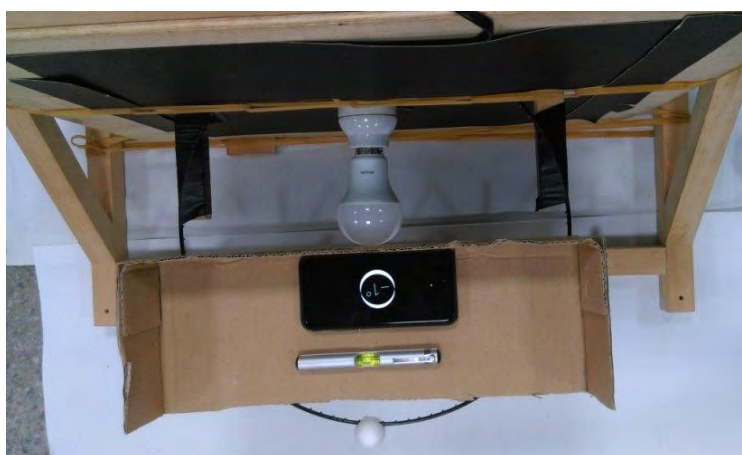
圖 2、運用水平檢測器與 APP 軟體檢測凌星軌道面的傾角(本圖係由上往下俯視拍攝)。
