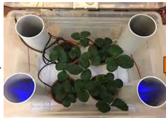
圖 16-2 固定兩個風扇向上吹風循環，控制溫度。溼度控制器調控在 55%~75%(此為植物適合的濕度環境)，低於 55%啟動另兩個風扇向下吹風增溼，高於 75%停止吹送。
