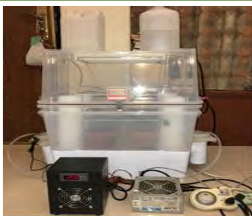
圖 4-1 實驗裝置實體圖 (箱內體積：55*38*54cm)
