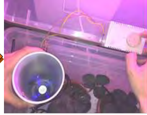
圖 15-5 套上導風管，風扇連接溼度控制器開關，加溼測試。
