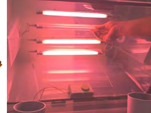
圖 16-3 調整 T5 燈管紅藍光比例及光照時間，觀察 2:2 及 3:1 之生長情形。
