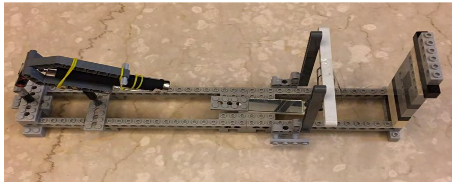
(圖28) 第四代縮小版光槓桿毛髮濕度計實體圖
