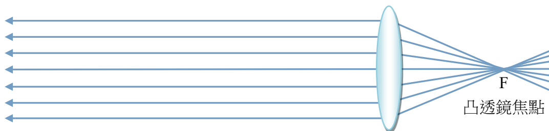
(圖 4-7)：凸透鏡模擬平行光示意圖
