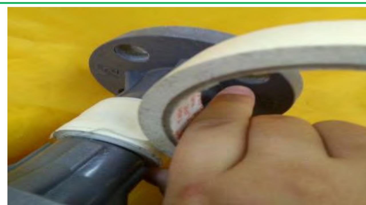
圖16 本組使用油漆用膠帶並用游標尺測量，改變線軸的內外徑比。
