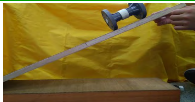
圖 41 將接觸面抬起到線軸滑落動並利用 Tracker 分析角度，求出值，代入 \tan \theta \theta = (\text{值} * 180) / \pi
