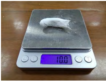
圖 37 在 控制線軸重量 的實驗時，將紙黏土平均的放入線軸的中心軸內(並儘量將其壓到最緊)。
