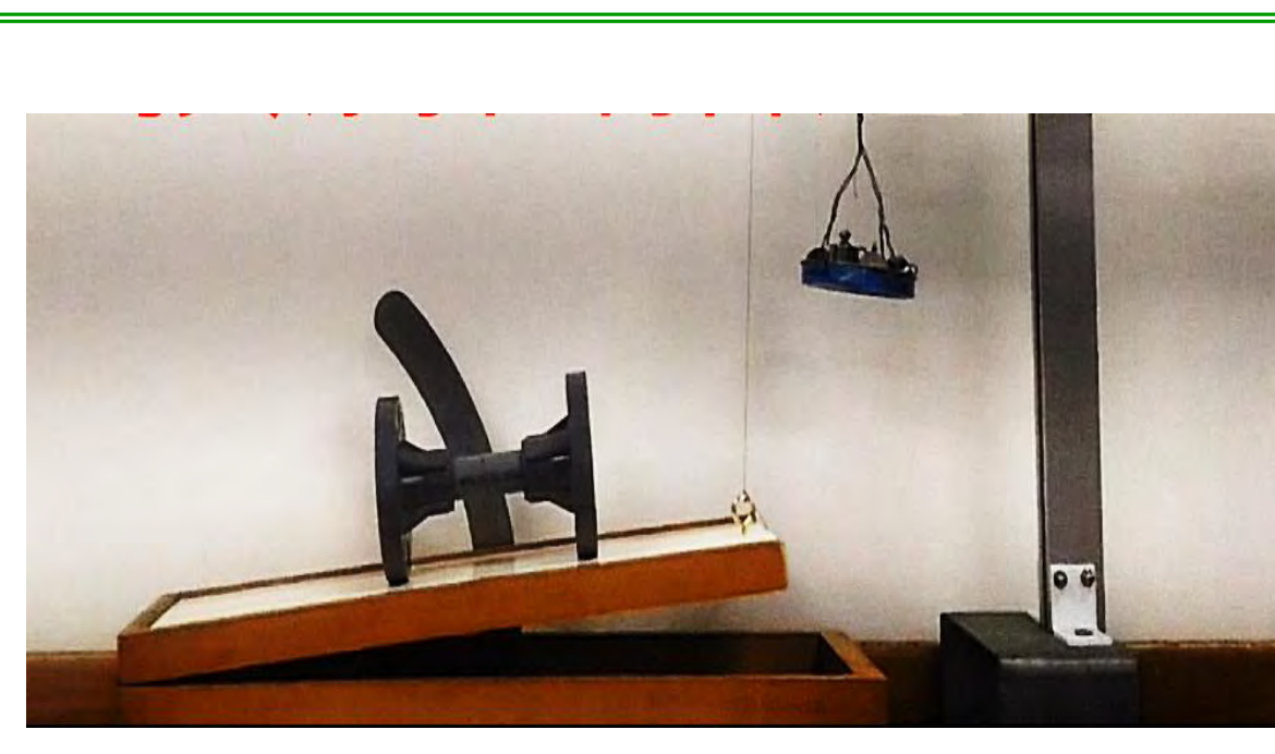
圖23將接觸面抬起到線軸滑動動並利用Tracker分析角度，求出值，代入 \tan \theta \quad \theta = (\text{值} * 180) / \pi
