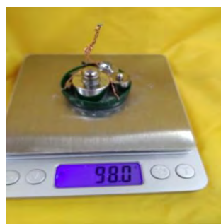
圖 27 測量秤盤及砝碼重量(即為拉力)
