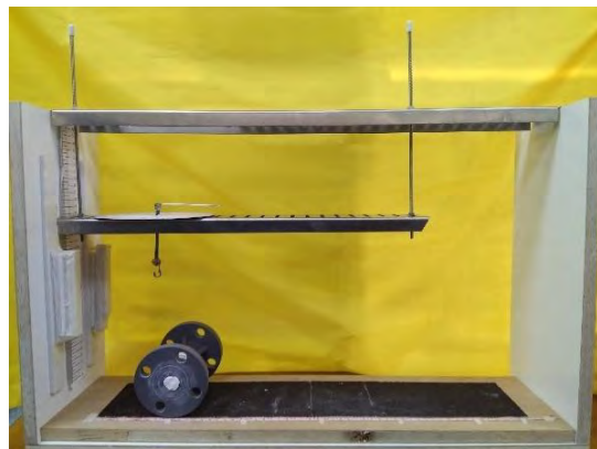
圖 39 本組在器材底部的接觸面，選擇了 4 種接觸面:砂紙、絨布、木板、白紙板
