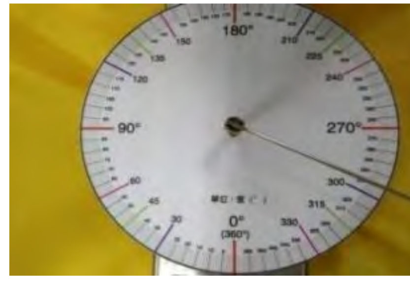
圖3 微調高度裝置： 利用螺旋桿黏上的指針，藉由轉動指針來微調定滑輪升降高度
