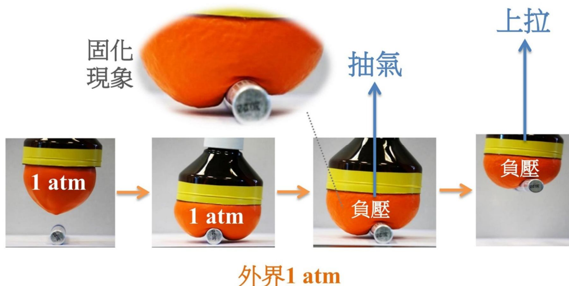
圖. 4. 負壓式夾球原理
