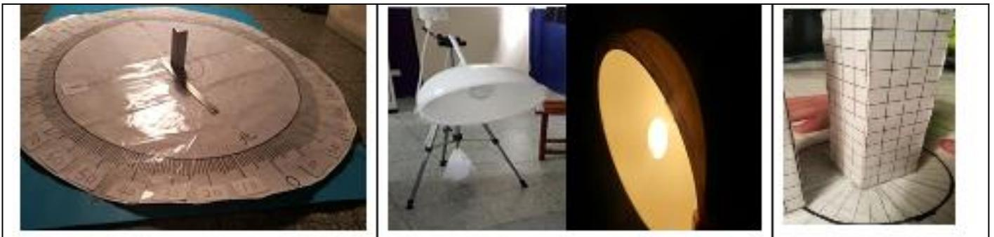
[圖五] 自製大型方位盤 70cmx70cm
