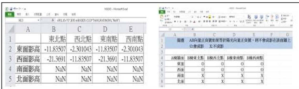
[圖二十] B 棟各點於 A 棟各面的影高 Hs [圖二十一] 建立是否遮蔽的判斷表
