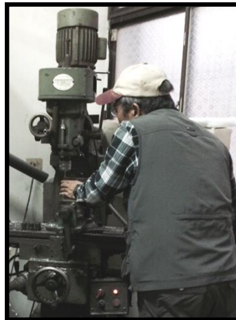
請老師的朋友用裁切模型飛機的機器幫我們鑽出直徑 3 公分的圓洞 ▲
