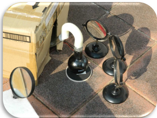
第一代陶瓷加熱片海淡裝置
