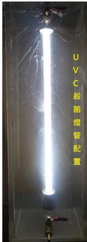
圖 11 UV-C 燈管配置圖
