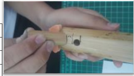
↑圖 11：進行吹嘴黏貼距離實驗時，我們在竹體上利用簽字筆做上刻度記號。
