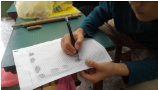
←圖 17：為了求出雨滴型面積，我們用方格紙來畫出兩滴形氣窗的面積大小，進行聲音頻率與響度的量測。
