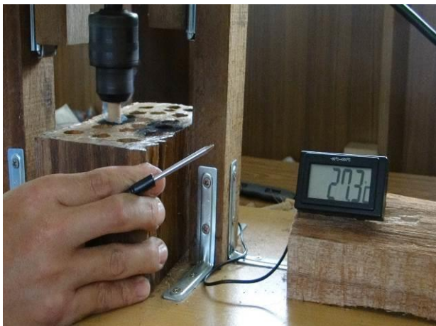
電鑽先開 1 分鐘，之後再用測溫棒測溫度
