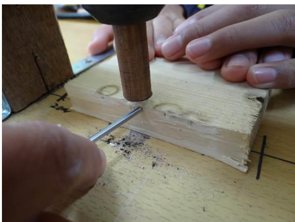
電子測溫棒放在接觸面下方
