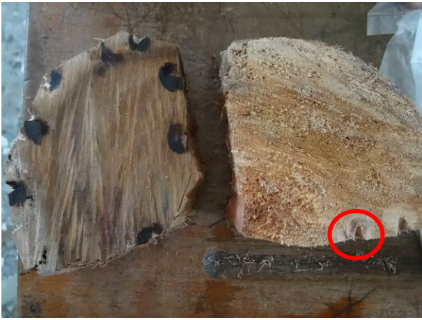
相思板上留下黑色炭化痕跡，山黃麻板則沒有（圈圈處是實驗的地方）
