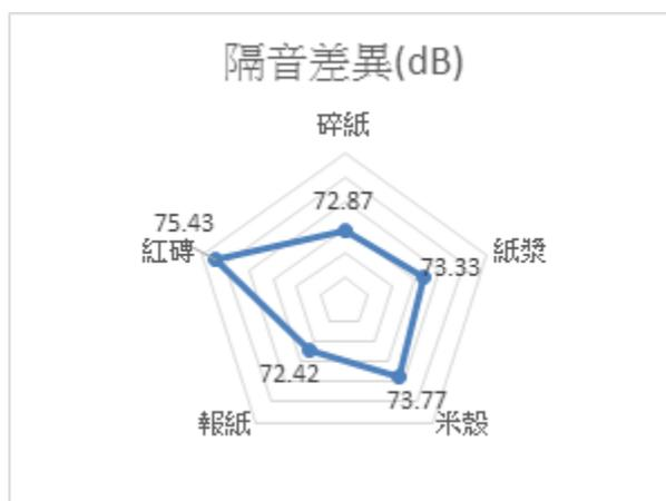
圖 12：不同材質磚塊的隔音差異
