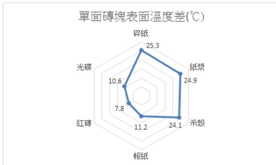
圖 5：0—40 分鐘不同材質單面磚塊的溫度差
