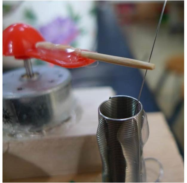
「金屬吉他弦」和「彈簧」是分開的，而且分別接上電線。當太陽能馬達轉動，牙籤推動金屬吉他弦，當它和彈簧碰在一起就形成通路。
