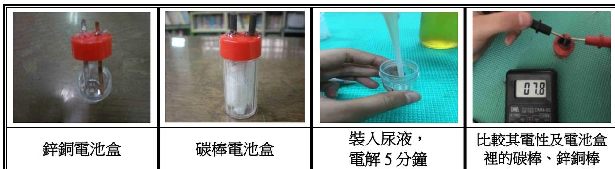
**測試結果：**鋅銅電池與燃料電池的**電性接近**，但**碳棒不會腐蝕**，可**不斷重複使用**。
